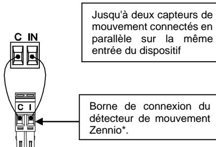
Jusqu'à deux capteurs de mouvement connectés en parallèle sur la même entrée du dispositif
