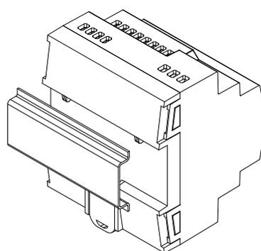
Figure 3: Montage de ALLinBOX 46 sur rail DIN
