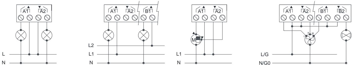
Figure 2: Exemples de connexions (de gauche à droite et de haut en bas): 2 charges, 2 charges sur différentes phases, volet, ventilateur avec 3 vitesse et vannes tout oui rien pour *fan coil* de deux tubes.
