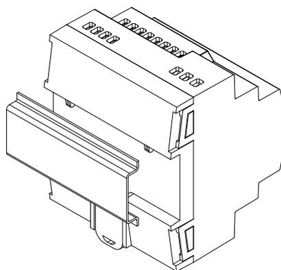
Figure 3: Montage du ALLinBOX Hospitality sur carril DIN
