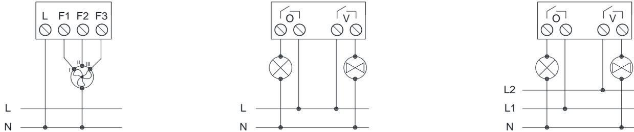
Figure 2: Exemple de câblage (de gauche à droite): ventilateur avec 3 vitesses, charge et vanne tout ou rien, charge et vanne tout ou rien à phases différentes.
