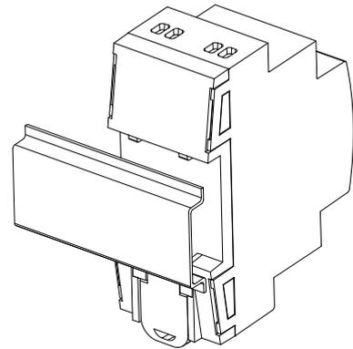
Figura 3: Montaje de FANinBOX 230V 1CH en carril DIN
