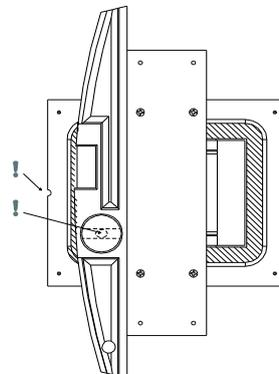
**5** Fixer l'accessoire aux guides du mur au moyen des vis adéquates (non incluses) [1]. Une fois fixée, on peut retirer la pièce auxiliaire de montage avec ses quatre vis [2].
