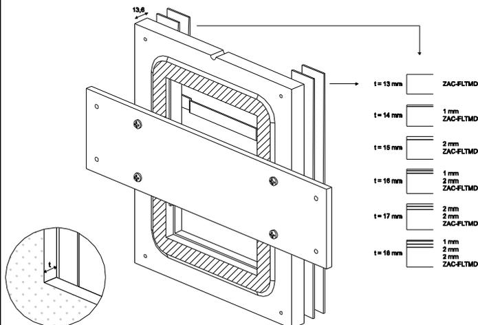
**4** Placer l'accessoire dans le trou et avec l'aide d'un niveau posé sur la pièce auxiliaire de montage, ajuster sa position horizontale (ou verticale) exacte.
