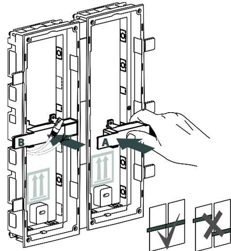
**5** Instalar la caja utilizando mortero, cemento cola o un material de construcción similar. Respetar la orientación y recuperar los cables.
