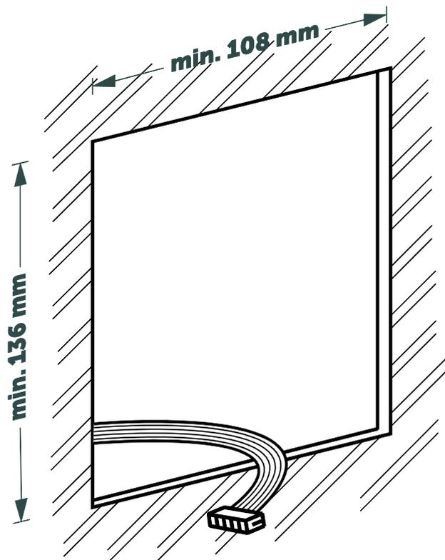
**2** Colocar la caja, recuperar el bus y fijar la caja mediante los tornillos que ajustan las pestañas al grosor de la pared. Poner atención en la orientación de la caja.
