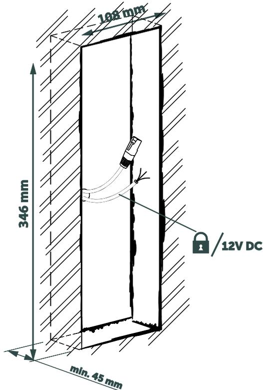
**2** Colocar las piezas auxiliares para montaje empotrado.
