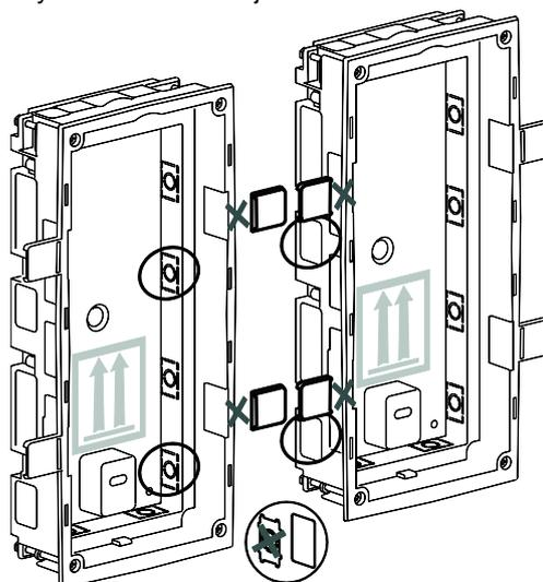
**3** Ensamblar las cajas con ayuda de las piezas auxiliares (A y B), las piezas tubulares y los tornillos.
