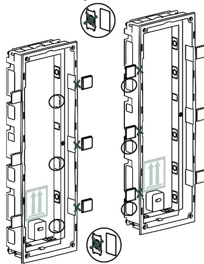
**3** Ensamblar las cajas con ayuda de las piezas auxiliares (A y B), las piezas tubulares y los tornillos.
