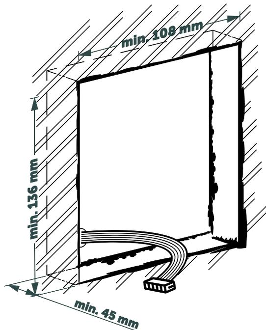
**2** Instalar la caja utilizando mortero, cemento cola o un material de construcción similar. Respetar la orientación y recuperar los cables.
