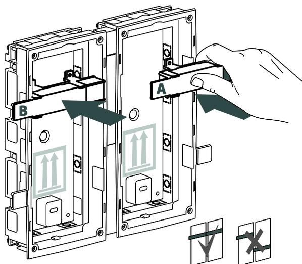
**5** Instalar la caja utilizando mortero, cemento cola o un material de construcción similar. Respetar la orientación y recuperar los cables.
