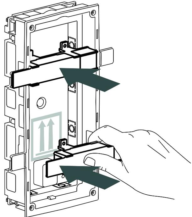
**3** Instalar la caja utilizando mortero, cemento cola o un material de construcción similar. Respetar la orientación y recuperar los cables.
