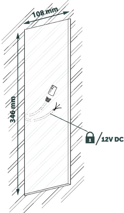
**2** Colocar la caja, recuperar los cables y fijar la caja mediante los tornillos que ajustan las pestañas al grosor de la pared. Poner atención en la orientación de la caja.
