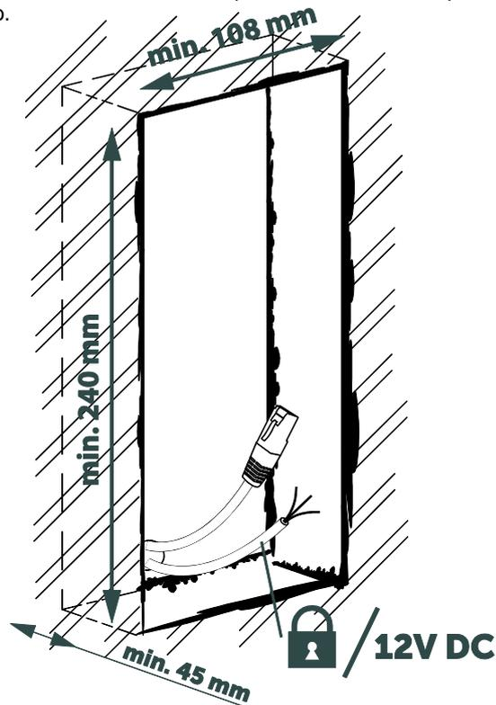
**2** Colocar las piezas auxiliares para montaje empotrado.
