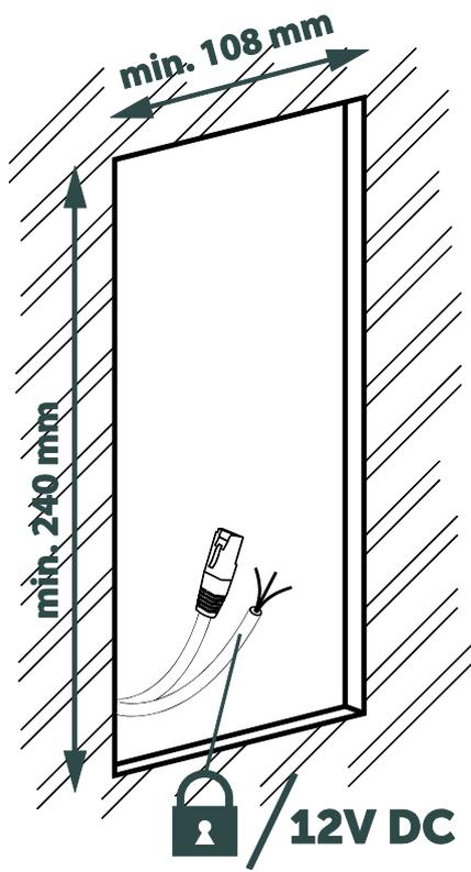
**2** Colocar la caja, recuperar los cables y fijar la caja mediante los tornillos que ajustan las pestañas al grosor de la pared. Poner atención en la orientación de la caja.
