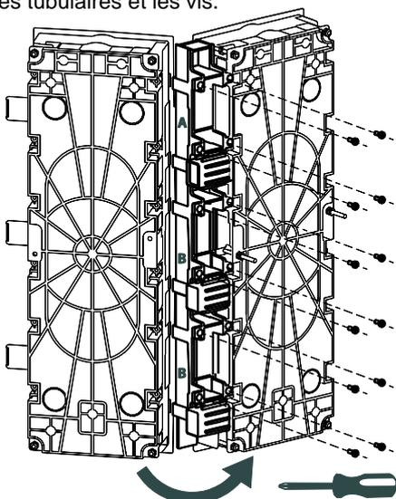
**4** Placez le boîtier, récupérez les câbles et fixez-le avec les vis qui ajustent la profondeur. Faites spécialement attention à l'orientation du boîtier.
