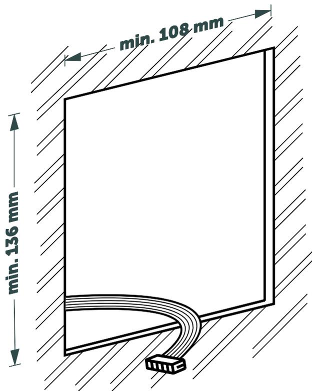
**2** Placez le boîtier, récupérez le bus et fixez-le avec les vis qui ajustent la profondeur. Faites spécialement attention à l'orientation du boîtier.
