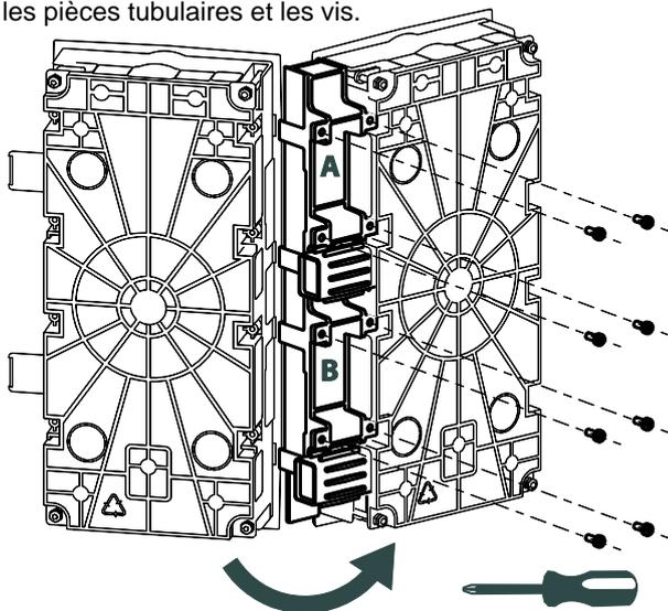
**4** Placez le boîtier, récupérez les câbles et fixez-le avec les vis qui ajustent la profondeur. Faites spécialement attention à l'orientation du boîtier.
