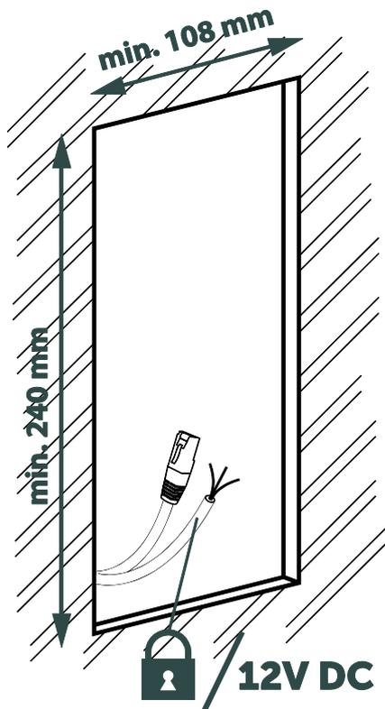
**2** Placez le boîtier, récupérez les câbles et fixez-le avec les vis qui ajustent la profondeur. Faites spécialement attention à l'orientation du boîtier.
