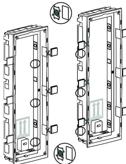
**3** Assemblez les boîtiers à l'aide des pièces auxiliaires (A et B), les pièces tubulaires et les vis.
