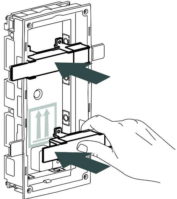
**3** Installez le boîtier en utilisant un mortier, un ciment-colle ou un matériau de construction similaire. Respectez l'orientation et récupérez les câbles.
