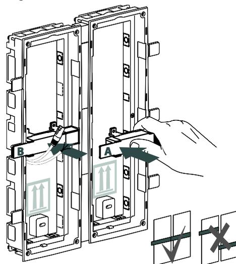
**5** Installez le boîtier en utilisant un mortier, un ciment-colle ou un matériau de construction similaire. Respectez l'orientation et récupérez les câbles.
