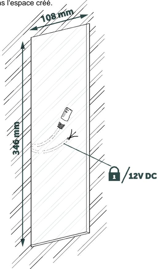
**2** Placez le boîtier, récupérez les câbles et fixez-le avec les vis qui ajustent la profondeur. Faites spécialement attention à l'orientation du boîtier.
