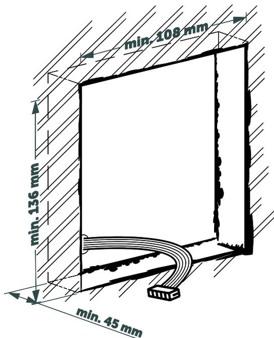
**2** Installez le boîtier en utilisant un mortier, un ciment-colle ou un matériau de construction similaire. Respectez l'orientation et récupérez les câbles.
