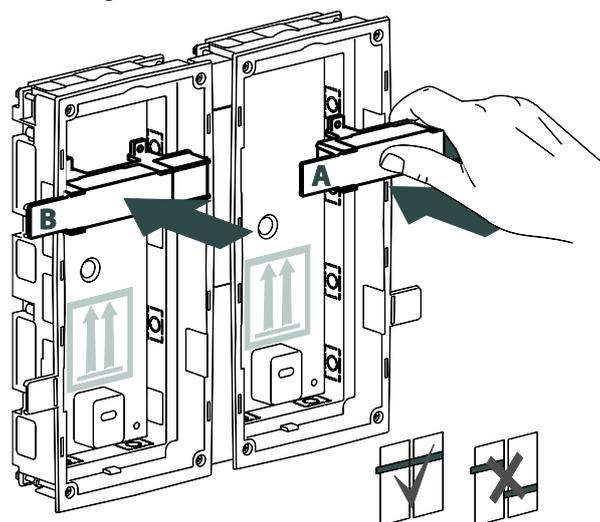
**5** Installez le boîtier en utilisant un mortier, un ciment-colle ou un matériau de construction similaire. Respectez l'orientation et récupérez les câbles.
