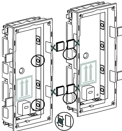
**3** Assemblez les boîtiers à l'aide des pièces auxiliaires (A et B), les pièces tubulaires et les vis.
