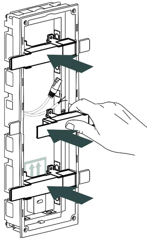
**3** Installez le boîtier en utilisant un mortier, un ciment-colle ou un matériau de construction similaire. Respectez l'orientation et récupérez les câbles.
