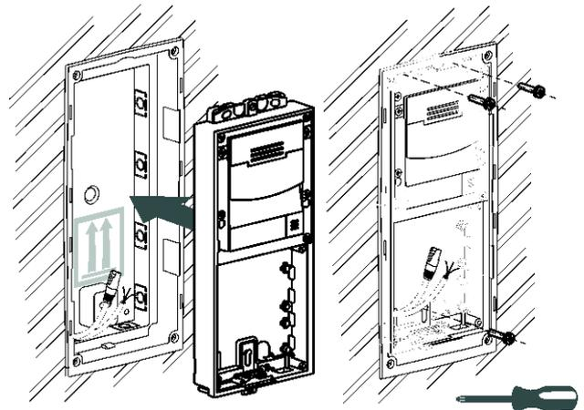
**3** Conectar el cableado de la unidad básica y colocar los módulos adicionales interconectando el bus.
