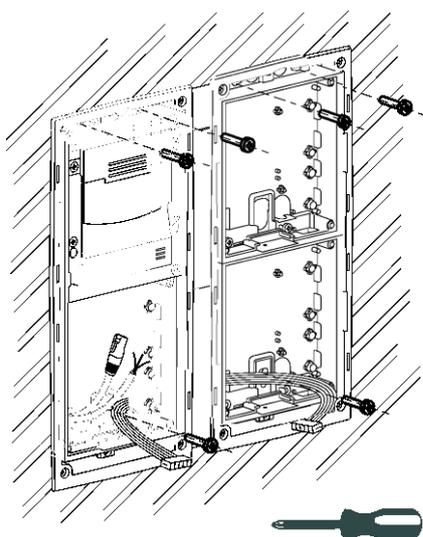
**4** Realizar las conexiones de la unidad básica y preparar los módulos adicionales. Pasar los cables de bus por los huecos.
