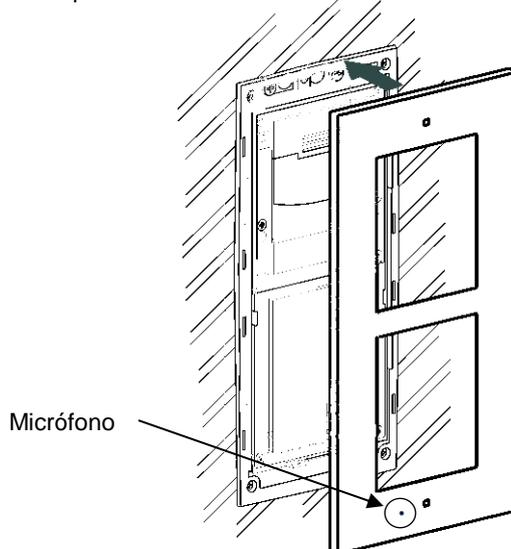
**2** Introduzca el cable del micrófono a través del orificio de la unidad básica tal como se muestra en la imagen. Tras esto, conéctelo a la conexión "MIC" de la unidad básica.
