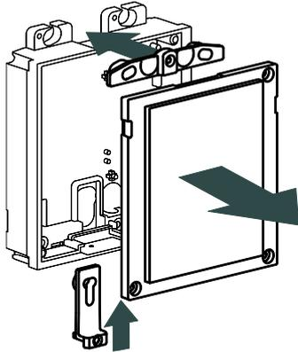
**2** Insertar la envoltura en la caja empotrada recuperando los cables. Fijar la envoltura con tornillos (incluidos).
