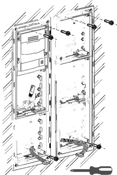
**4** Realizar conexiones de la unidad básica y preparar los módulos adicionales. Pasar los cables de bus por los huecos.
