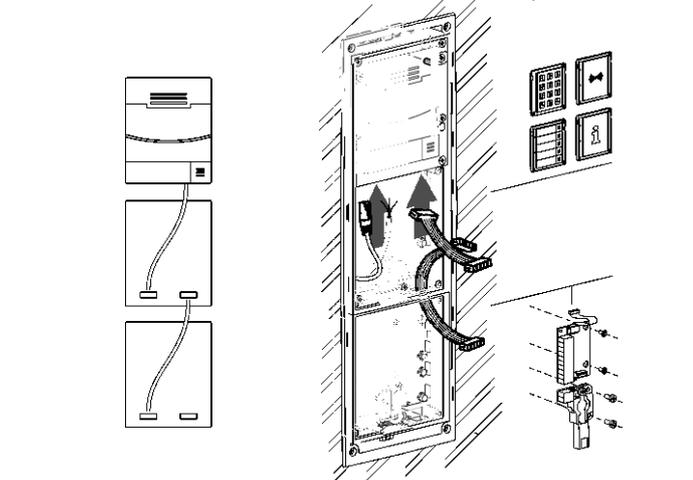
**4** Fijar la tapa (o módulos adicionales que queden a la vista) con los tornillos suministrados y colocar las etiquetas con los nombres junto a los botones.
