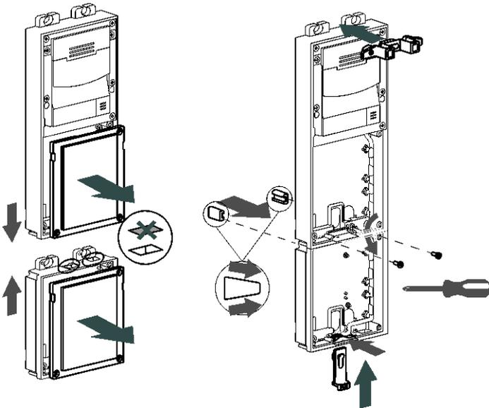
**2** Insertar el montaje en la caja empotrada recuperando los cables. Fijar el montaje con tornillos (incluidos).
