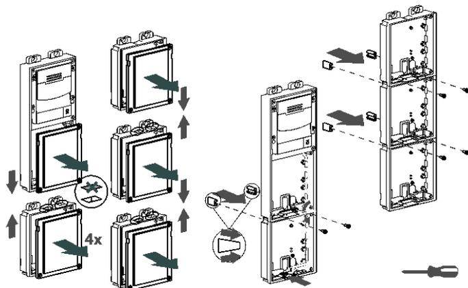
**2** Colocar las piezas metálicas auxiliares suministradas con los marcos. Insertar los montajes en las cajas empotradas pasando previamente el bus entre las columnas y recuperando los cables.
