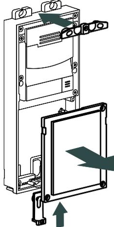
**2** Insertar la unidad básica en la caja empotrada recuperando los cables. Fijar la envolvente con tornillos (incluidos).
