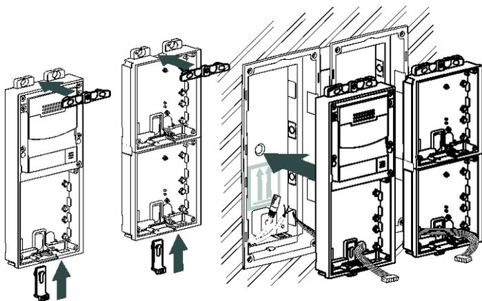
**3** Fijar los montajes a las cajas empotradas con tornillos.
