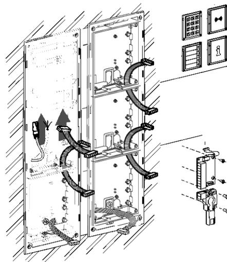
**5** Realizar el conexionado de bus como indica el esquema y fijar los módulos opcionales que quedan a la vista con tornillos.
