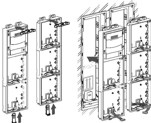
**3** Fijar los montajes a las cajas empotradas con tornillos.
