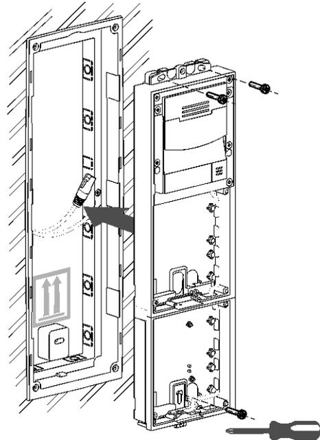
**3** Conectar el cableado de la unidad básica y colocar los módulos adicionales interconectando el bus como muestra el esquema.
