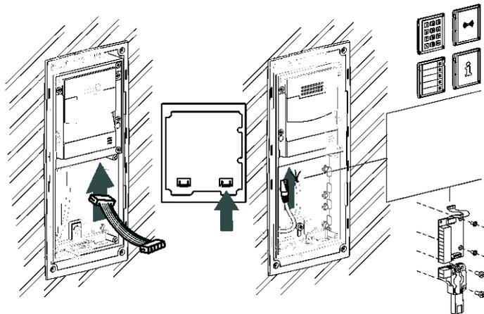
**4** Fijar la tapa (o módulos adicionales que queden a la vista) con los tornillos suministrados y colocar las etiquetas con los nombres junto a los botones.
