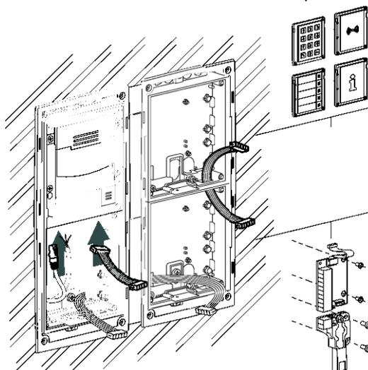
**5** Realizar el conexionado de bus como indica el esquema y fijar los módulos adicionales que quedan a la vista con tornillos.
