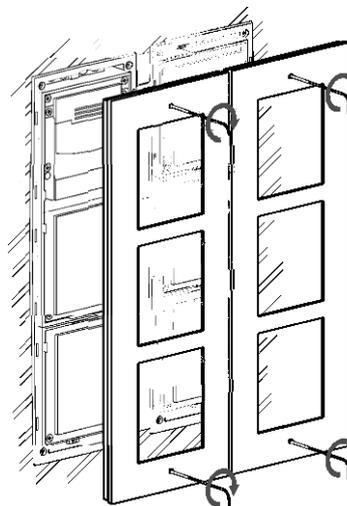
\*В случае присутствия акустических дефектов, Zennio может предоставить модифицированную рамку, для установки которой шаг номер 1 следует пропустить. В этом случае, однако, очень важно, чтобы микрофон оставался правильно подключенным.
