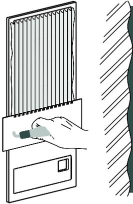
**2** Ajustez la plaque au mur en passant les câbles au travers du trou situé dans la partie inférieure gauche. Laissez passer le temps de prise du mortier-colle.
