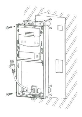
Colocar y fijar el Marco de Superficie ZVP-CB2M con la llave Allen.
