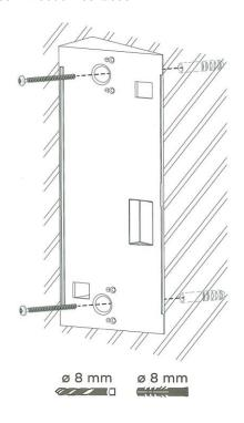
**3** Fijar la unidad básica a la placa mediante los tornillos suministrados con la primera.
