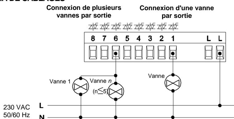
**NOTE:** La connexion simultanée d'une vanne à plus d'une sortie n'est pas permise.
