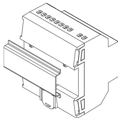
Figure 3: Montage du dispositif sur rail DIN
