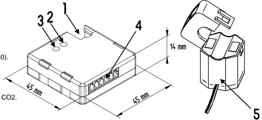
**Botón de programación:** permite seleccionar el modo programación. Si se mantiene pulsado al aplicar la tensión de bus fuerza al aparato a colocarse en "modo seguro".
