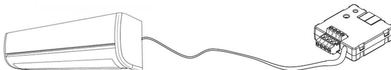
Figura 2. Cableado de KLIC-MITT a máquina Mitsubishi
