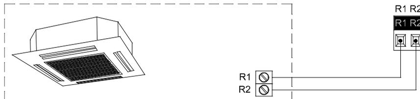
Figure 2: Câblage du KLIC-PA à l'appareil de climatisation
