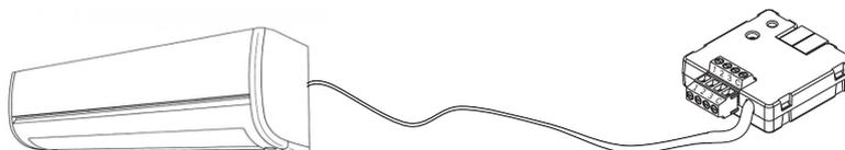
Figura 2. Cableado de KLIC-DD3 a máquina Daikin
