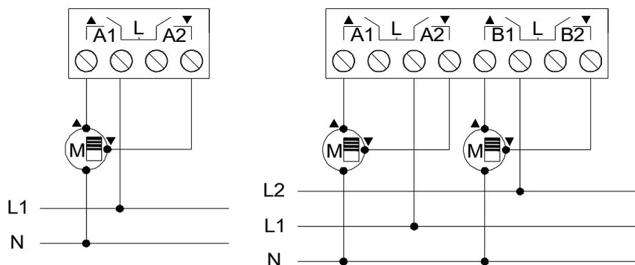
⚠ Pour être sûr de l'état prévu des relais, veuillez brancher le bus KNX au dispositif avant d'alimenter le circuit de puissance.
