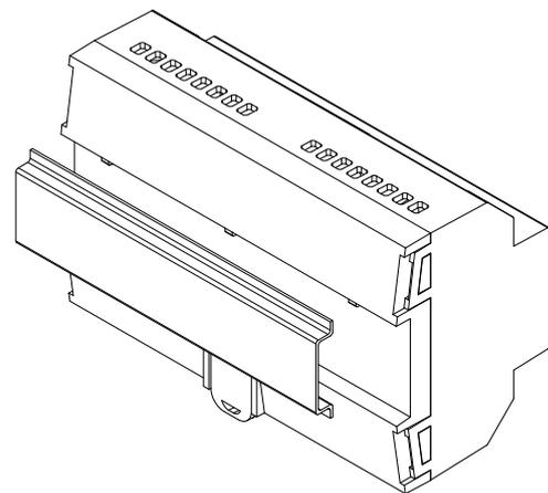
Figure 3: Montage du dispositif sur rail DIN
