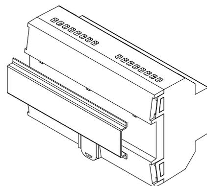
Figura 3: Montaje de MAXinBOX 16 Plus en carril DIN
