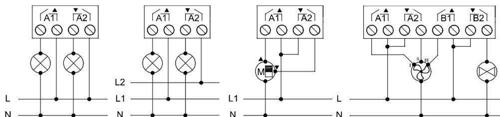
⚠ Pour être sûr de l'état prévu des relais, veuillez brancher le bus KNX au dispositif avant d'alimenter le circuit de puissance.
