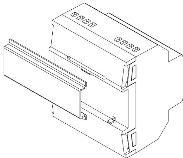
**Рисунок 3.** Установка MAXinBOX 8 Plus на DIN рейку
