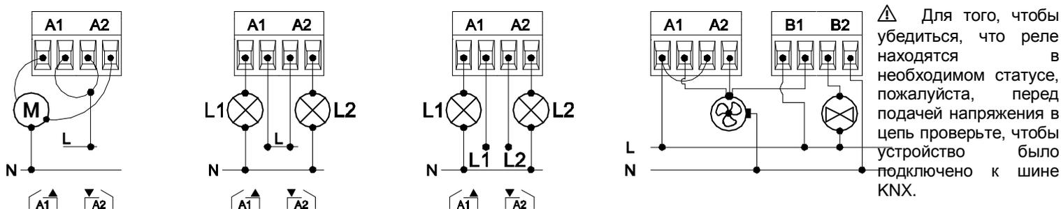
**Рисунок 2.** Примеры соединений (слева направо): канал А как канал жалюзи, индивидуальные выходы канала А с одинаковыми и разными фазами и канал А и В как контроллер фанкойлов (2-трубный и 3-скоростной вентилятор).
