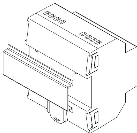
Figura 3: Montaje de MAXinBOX 8 v3 en carril DIN
