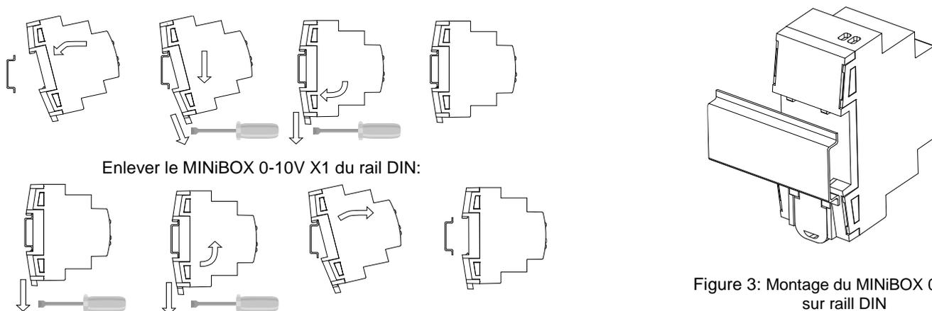
Figure 3: Montage du MINiBOX 0-10V X1 sur rail DIN
