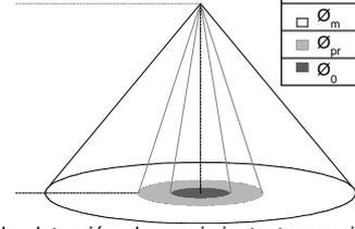
$\varnothing_m$ : Zona de detección de movimiento tangencial. Para movimiento perpendicular al sensor se reduce la zona de detección (ver consejos de instalación).
