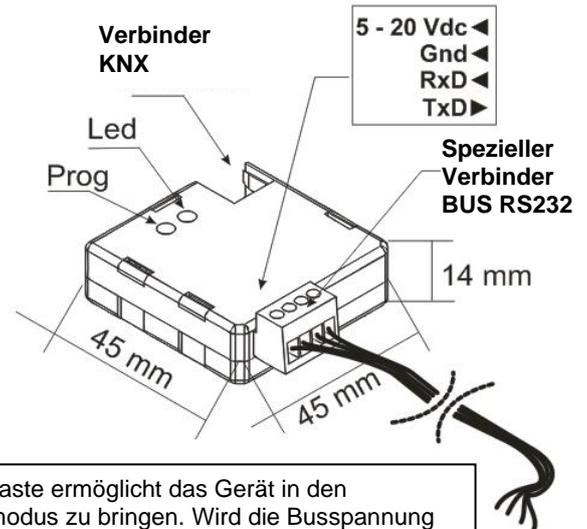
**Prog:** Diese Taste ermöglicht das Gerät in den Programmiermodus zu bringen. Wird die Busspannung bei gedrückter Taste angelegt, geht das Gerät in den "Sicherheitsmodus".
