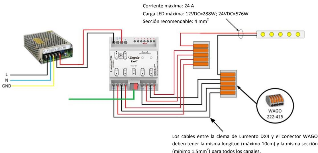
Nota importante: La longitud máxima que se puede poner entre el conector WAGO y la tira debe calcularse en base a la caída de tensión permitida para una correcta regulación, la corriente consumida por la tira y la sección del cable utilizado.
