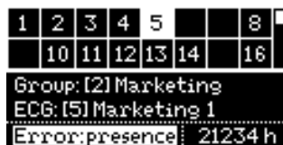
Figure 34. Erreurs du ballast
