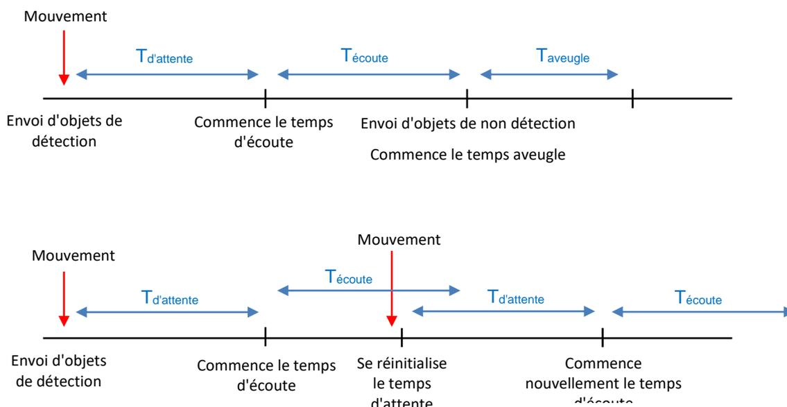
Figure 4. Principe de fonctionnement du détecteur de mouvement.
