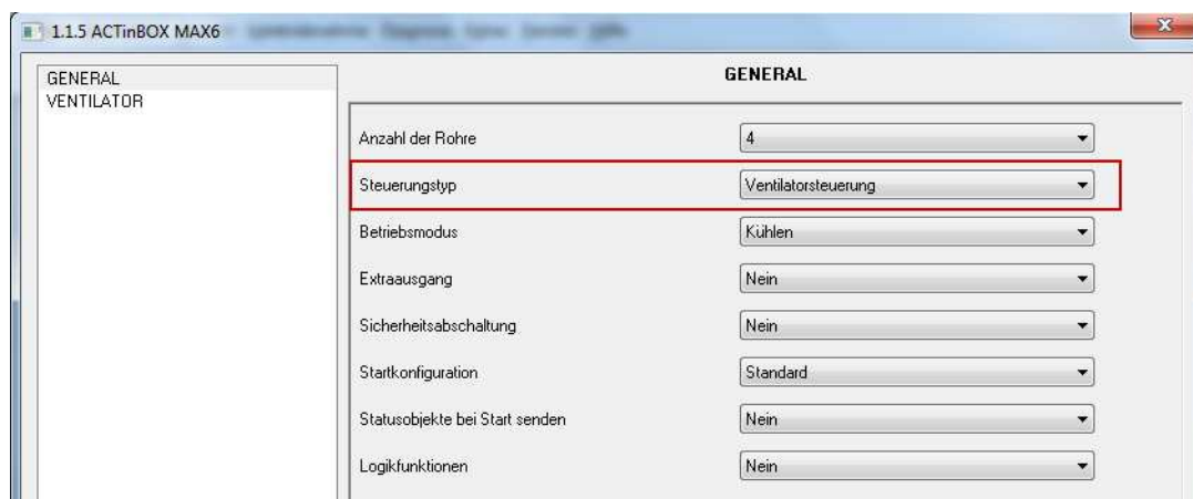
Bild 3.3. Wahl des Steuerungstyp: Ventilatorsteuerung
