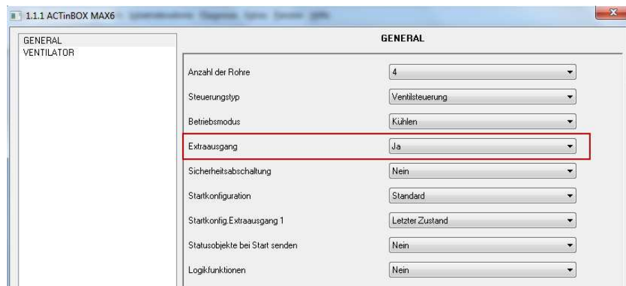
Bild 3.13 Extraausgang im 4-Rohr System.
