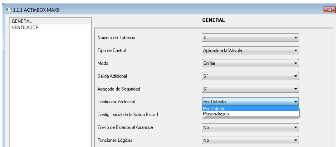
Figura 3.16. Configuración inicial de Fan Coil
