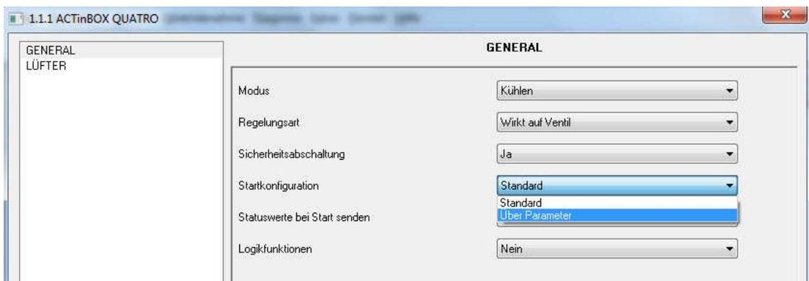
Bild 3.17 Startkonfiguration des Fan Coils
