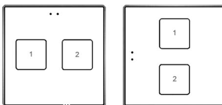
Figura 12 Flat 2. Orientación normal (izquierda) y rotada (derecha).
