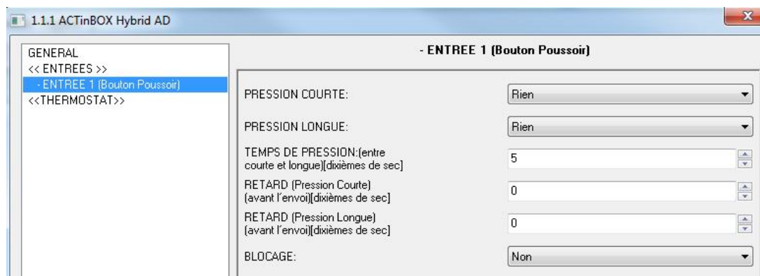
Figure 20. Entrée binaire: Bouton poussoir
