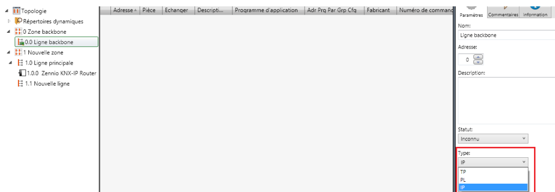
Figure 11 Zennio KNX-IP Router comme coupleur de zones.
