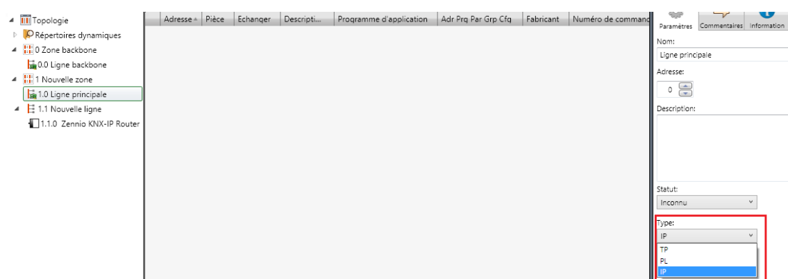
Figure 12 Zennio KNX-IP Router comme coupleur de lignes.
