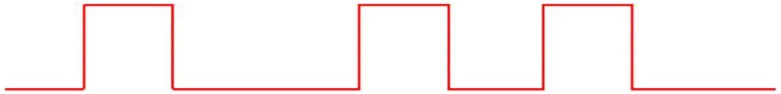
Diese Methode wurde in alten Fernbedienungen benutzt, und wurde ersetzt durch die Benutzung einer Trägerfrequenz. Diese Methode ist unempfindlicher gegenüber Störeinflüssen von anderen Lichtquellen. In diesem Fall wird die Infrarotübertragung einer Trägerfrequenz überlagert. Üblicher Frequenzbereich: [30kHz...56kHz] Ein Impuls wird in diesem Fall über die Trägerfrequenz realisiert, wie im folgenden Bild dargestellt:
