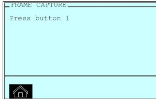
Es ist unwichtig welche Taste betätigt wird, diese muss jedoch als Taste 1 bezeichnet werden, und nachfolgend müssen bei Aufforderung unterschiedliche Tasten gewählt werden, und diese als 2 und 3 bezeichnet werden, da der Prozess der Analyse des Rahmens das zweimalige Betätigen dreier Tasten vorsieht.
