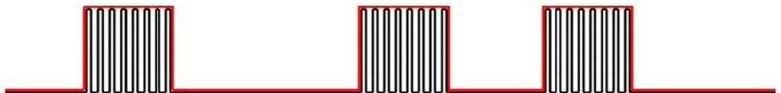
Der IRSC Open unterstützt nur die Infrarotübertragung mit Trägerfrequenz.
