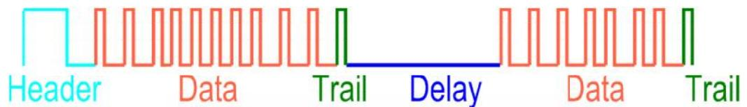
Die Ganzheit dieser Impulsfolge wird Rahmen genannt. Zum besseren Verständnis des Diagramms ist die Trägerfrequenz ausgeblendet.
