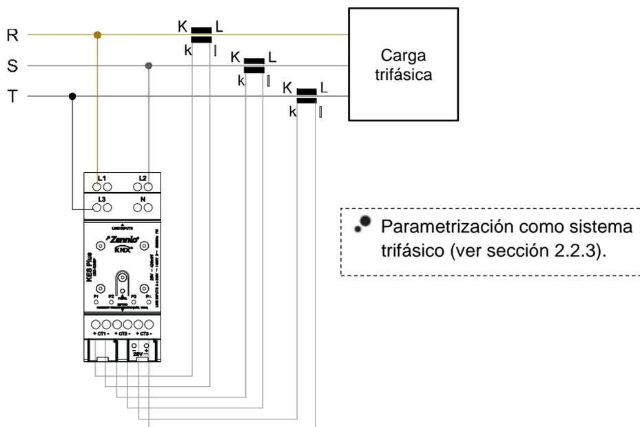
Figura 5 Trifásica sin neutro y carga trifásica.
