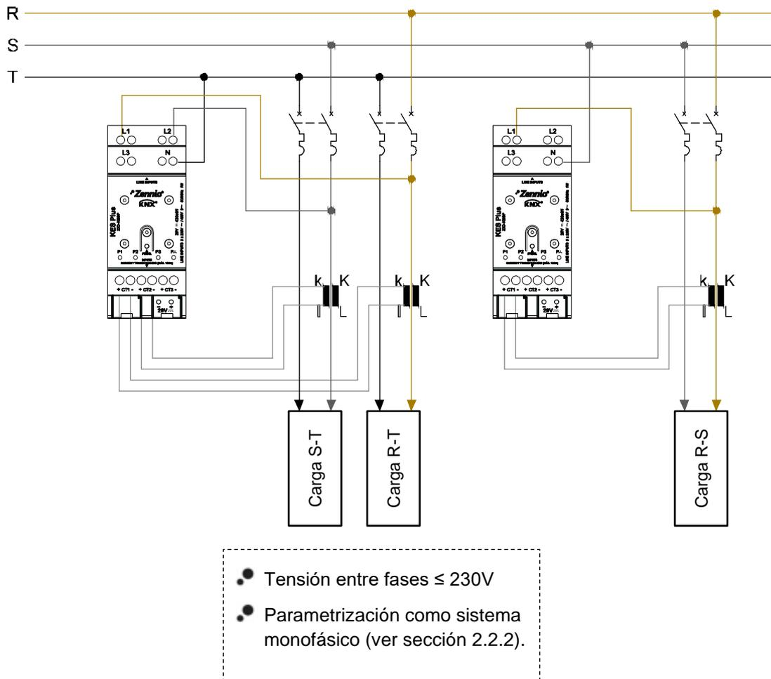
**Figura 6** Trifásica sin neutro y cargas monofásicas.
