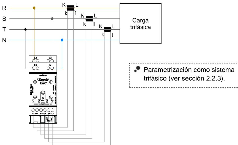
Figura 2 Trifásica con neutro y carga trifásica.
