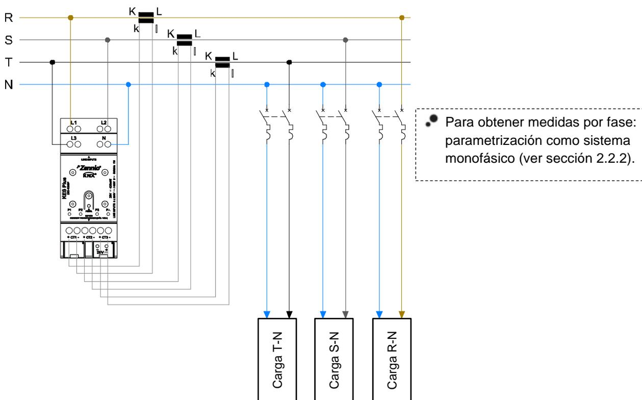
Figura 3 Trifásica con neutro y cargas monofásicas.
