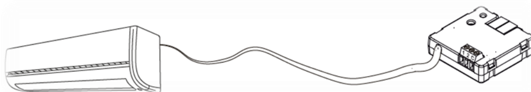
Figure 2. Connexion du KLIC-DD V3 à la machine d'A/C.
