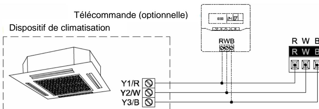
Figure 2. Connexion du KLIC-FJ à la machine d'A/C.
