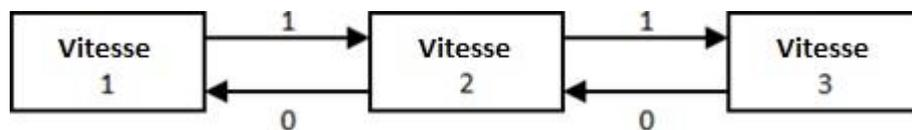
Figure 9. Contrôle du ventilateur par pas non cyclique sans mode auto (avec 3 vitesses).
