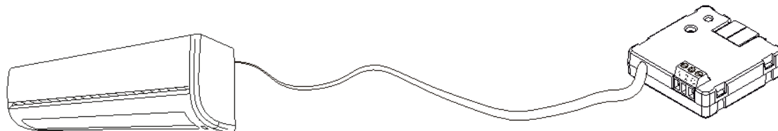
Figure 2. Connexion du KLIC-MITT v2 à la machine d'A/C
