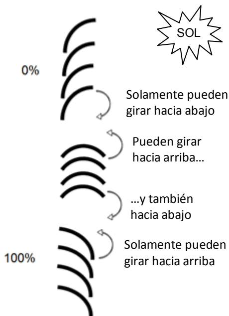
Figura 20. Posiciones "arriba" y "abajo" de las lamas
