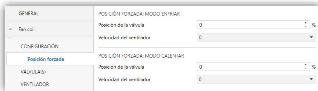
Figura 9 Fan coil – Posición forzada.
