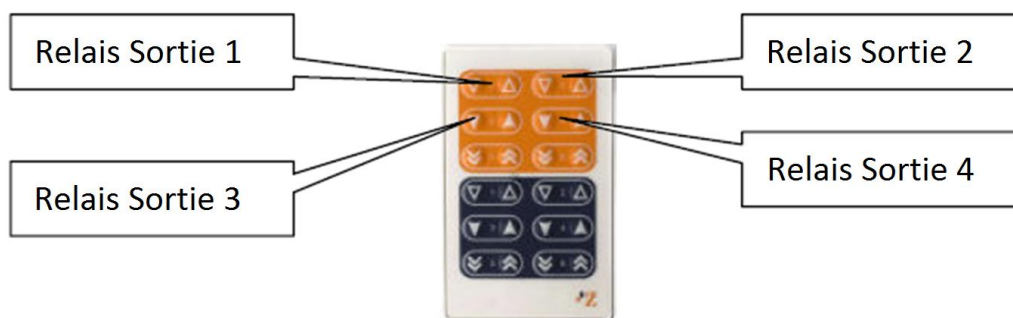
Figure 3. Zones d'appui sur la télécommande
