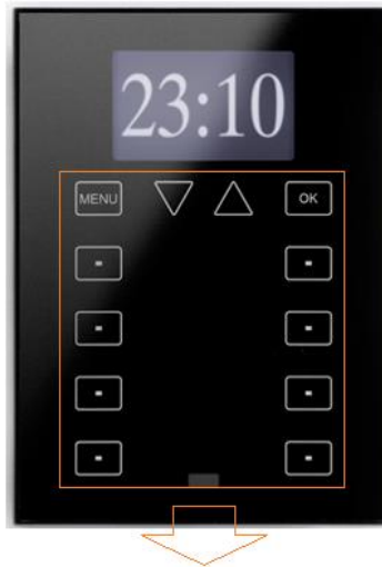
Figure 5. Zone d'appui tactile
