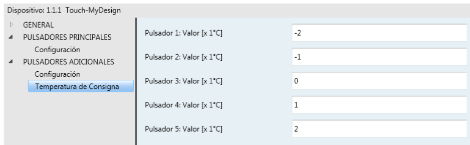
Figura 16 Temperatura de consigna (Pulsadores adicionales)
