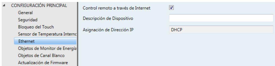
Figura 22 Ethernet (Configuración principal)
