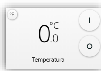
Figura 76. Control 2 botones de Temperatura (casilla)
