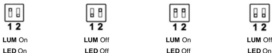
Figure 4. Position des doubles micro-interrupteurs
