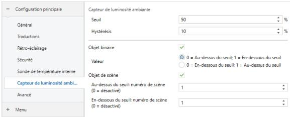
Figure 2. Capteur de luminosité ambiante
