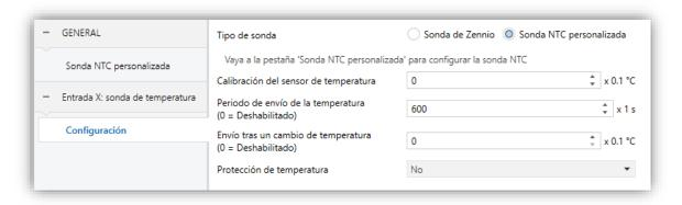
Figura 1. Sonda de temperatura - Configuración.
