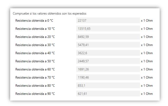
Figura 3. Sonda NTC personalizada – Valores de resistencia esperados
