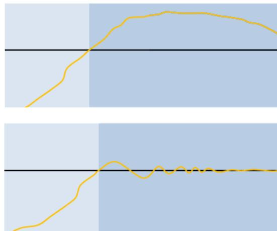
Figure 6. Effet de réinitialiser ou non l'erreur accumulée après saturation.
