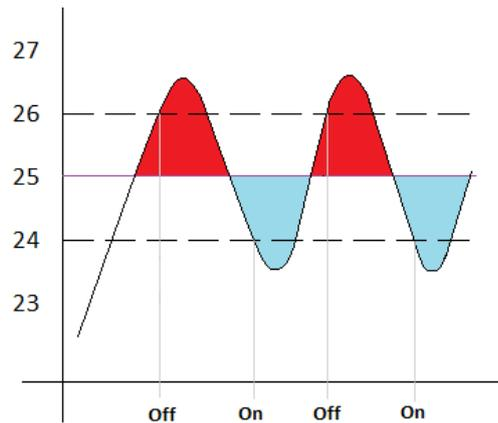
*Les sections de couleur rouge se correspondent avec des situations de consommation énergétique in nécessaire et de faute de confort pour excès de température. Pour sa part, les sections de couleur bleu signalent des situations de faute de confort pour défaut de*
