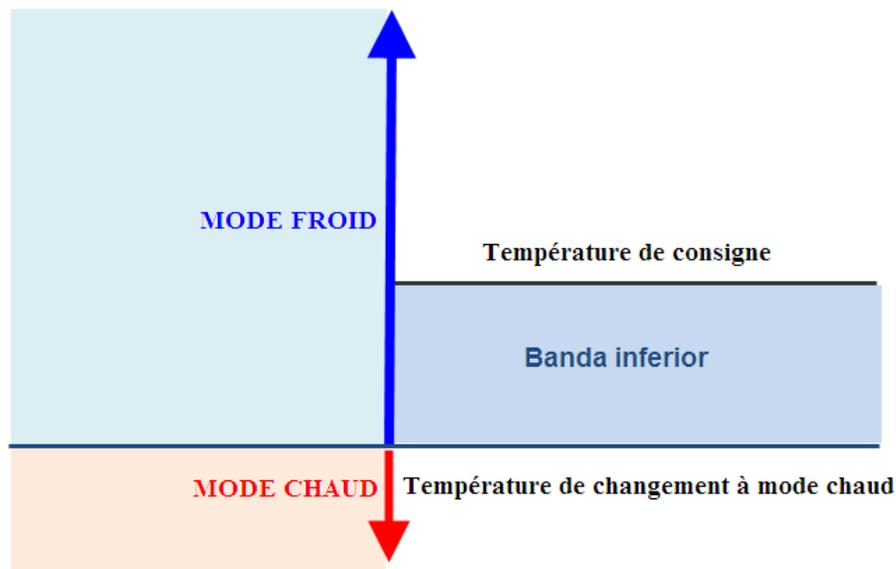
Figure 2. Modes de fonctionnement: changement de mode froid à mode chaud.
