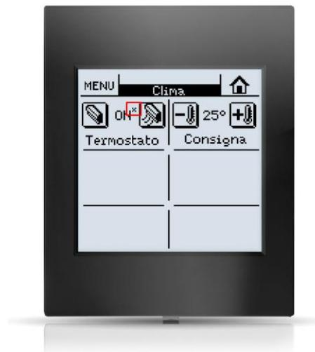
Figure 11. Écran Z38i: Indicateur de la variable de contrôle PI-PWM.
