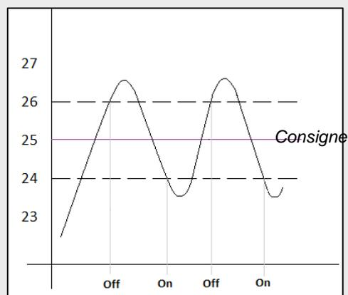
Le problème de ce type de contrôle, en comparaison avec d'autres systèmes plus avancés, est l'oscillation permanente autour de la température de consigne qui agit de manière directe sur la consommation énergétique et sur le confort.
