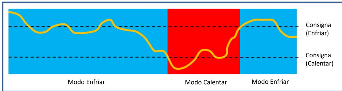
Figura 1. Cambio de modo automático.
