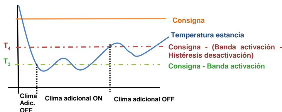
Figura 6. Activación y desactivación del sistema adicional en modo calor.
