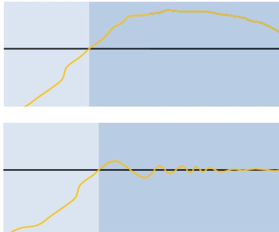
Figura 4. Efecto de reiniciar o no el error integral acumulado tras saturación.
