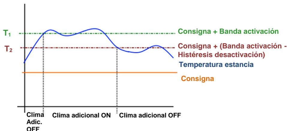
Figura 5. Activación y desactivación del sistema adicional en modo enfriar.
